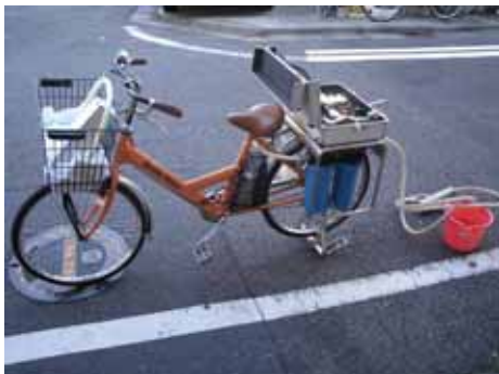
自転車搭載型緊急用浄化装置 「シクロクリーン」
