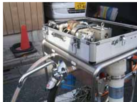
自転車搭載型緊急用浄化装置 「シクロクリーン」
